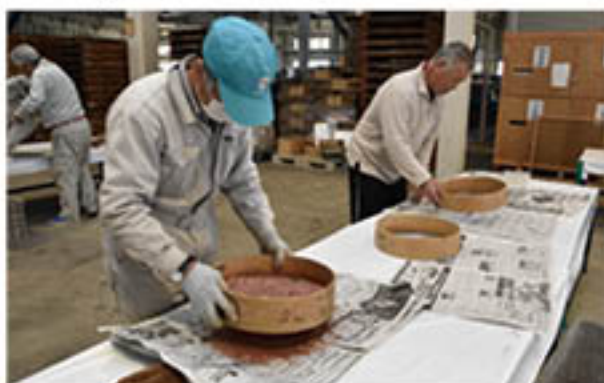
開薬器にかける前にふるいで薬と花カスを分ける生産者
